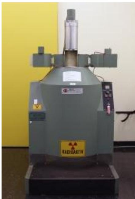
Figura 4.2 - Irradiador de Cobalto-60, Gamma Cell 220 I.
