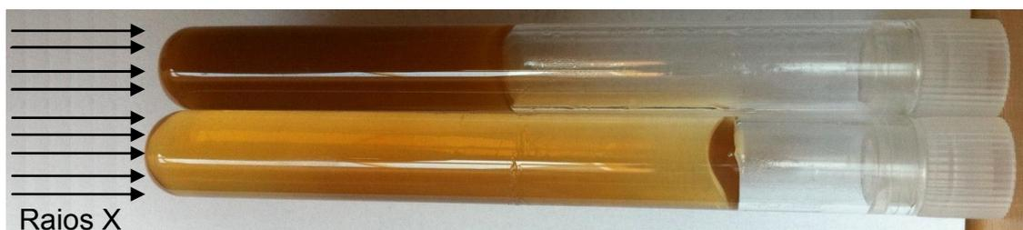
Figura 5.52 - Tubos de ensaio com gel polimérico puro e com gel polimérico com ouro, com irradiação pelo lado esquerdo.
